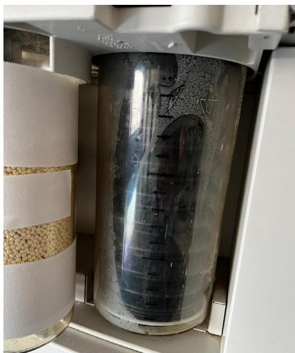
Figura 13.3. Ventilador de concertina ascendente.
