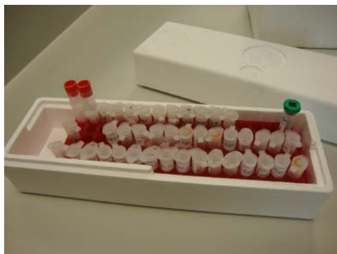
Figura 4.14. Caja de poliestireno. Las muestras que se van a remitir a un laboratorio especializado deben embalarse adecuadamente y remitirse en una caja de poliestireno a través de un servicio de mensajería.
